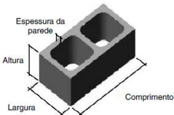
**Figura 1 – Bloco vazado de concreto simples**
