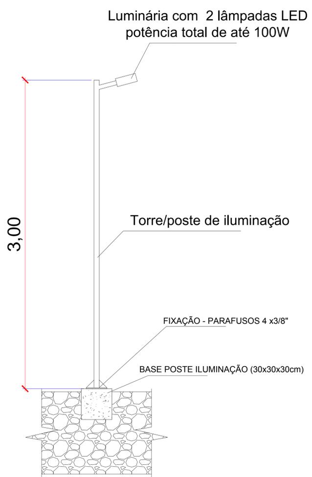
DETALHE POSTE DE ILUMINAÇÃO SEM ESCALA
