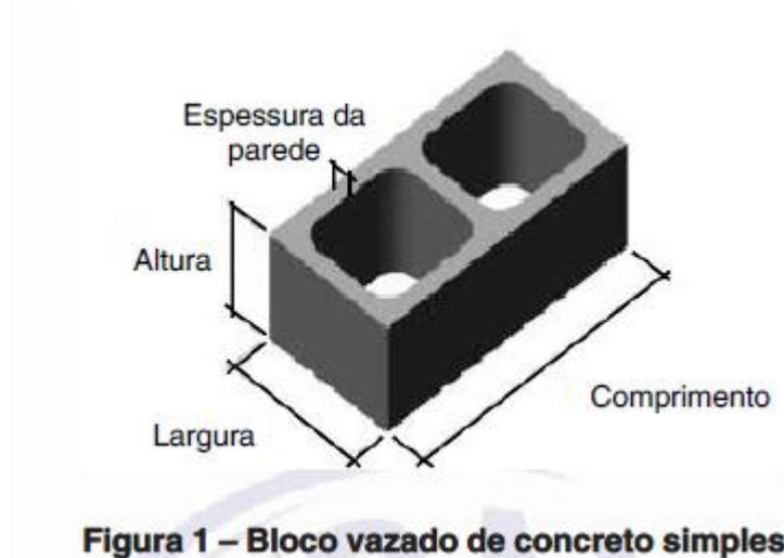
**Figura 1 – Bloco vazado de concreto simples**
